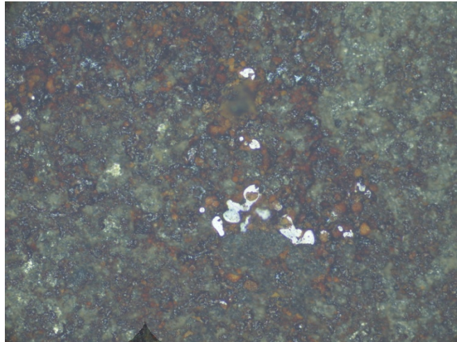
Gambar 5.19 Kupon pada CO 2 1 % dengan laju korosi 0,0003 mm/tahun.
