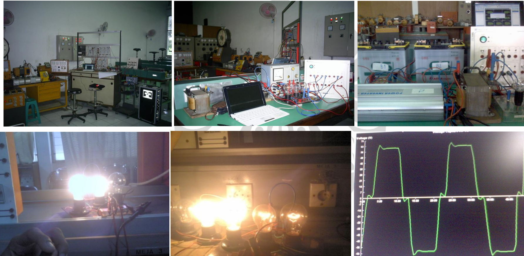
Gambar 4.9. Perangkat pengujian model jaringan listrik mikro arus searah dengan beban yang bervariasi (Gambar a-e) dan bentuk gelombang inverter (Gambar f)
