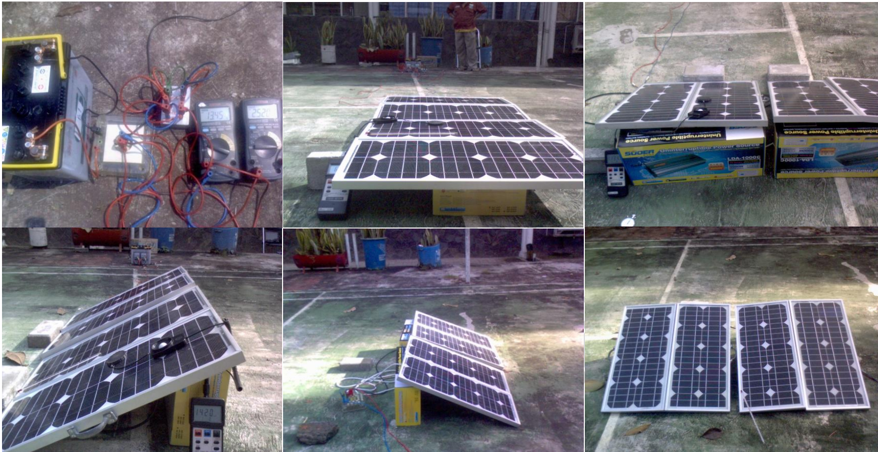
Gambar 4.2 Perangkat pengujian modul sel surya dalam kondisi baru pada bulan Mei-Juni 2010 (keterangan sesuai arah jarum jam): baterai dan alat ukur, berbagai arah modul sel surya: datar, utara, selatan, timur, barat
