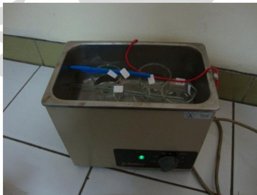
**Gambar 3.6** Proses pembersihan sampel dengan aseton di dalam *ultrasonic bath*.
