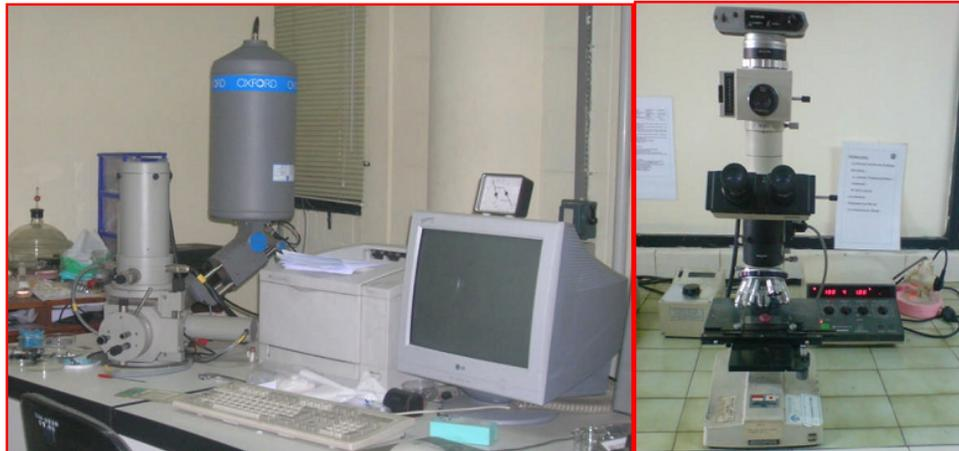
Gambar 3.8 Alat SEM dan mikroskop optic
