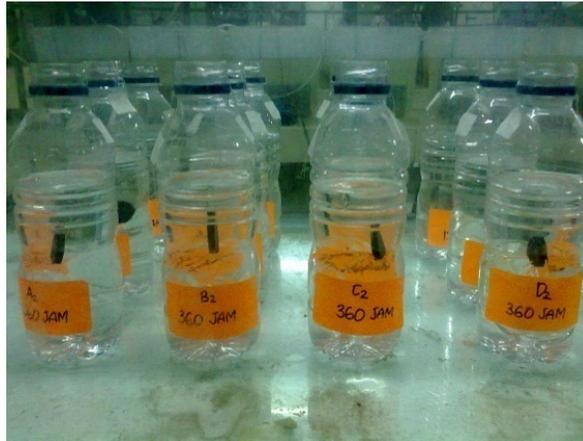
**Gambar 3.7** Pengujian dengan metode uji celup dalam larutan  $H_2SO_4$  4 % 0.75 M aerated.
