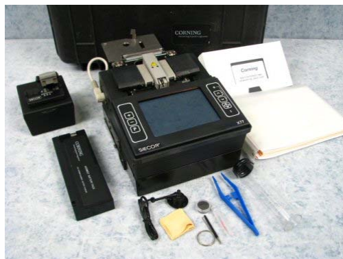
Gambar 2.6 Alat untuk Menyambung Serat Optik ( Fiber Fusion Splicer )
