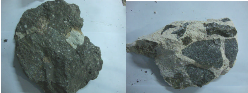
Gambar 4.7 Permukaan patahan geopolimer abu terbang (kiri) dan geopolimer metakaolin (kanan)
