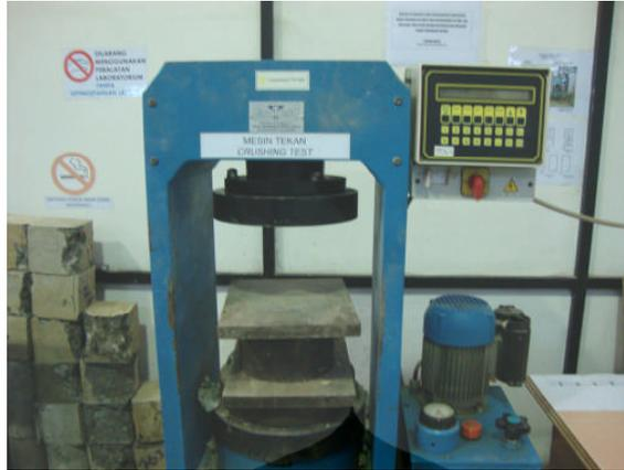
Gambar 3.7 Mesin Penguji Kuat Tekan
