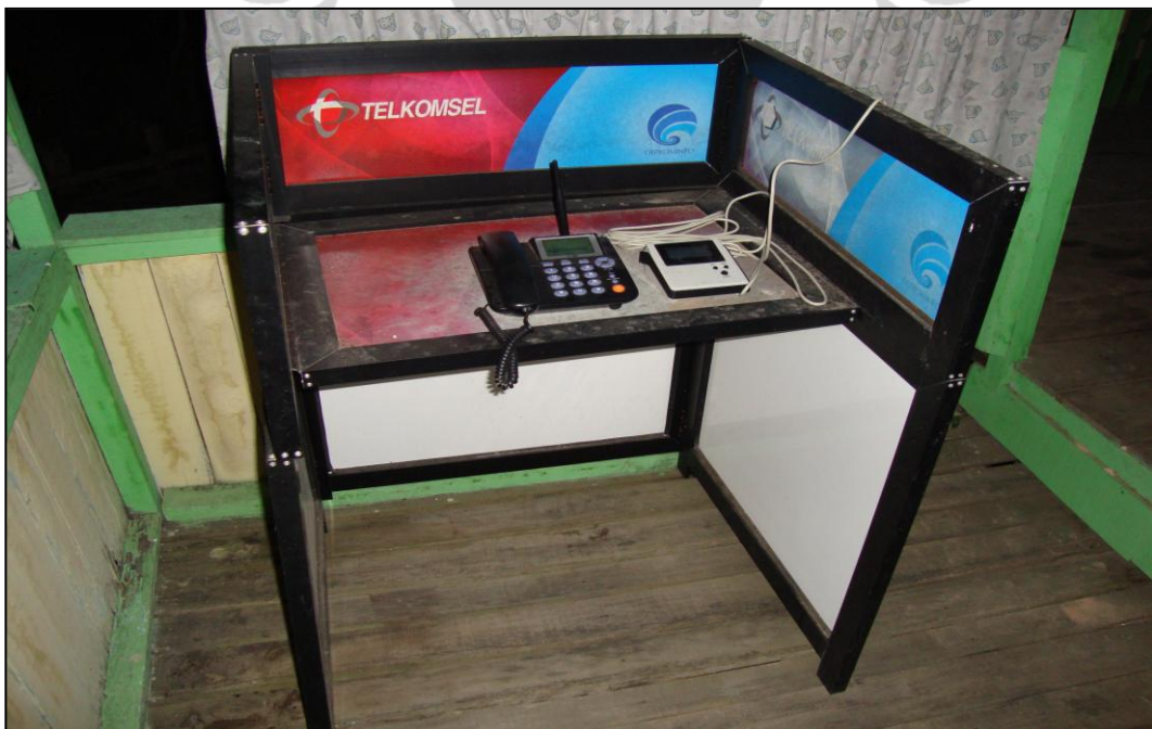
Perangkat FWT, KBU, & Display Billing Untuk Semua Desa KPU/USO ST 1, ST 2, dan ST 3
