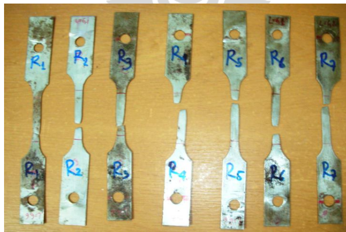
Gambar 5.15. Spesimen yang telah diuji tarik dengan mesin uji tarik prototip-3 dengan dudukan loadcell yang telah dimodifikasi
