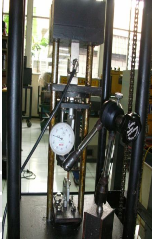
Gambar 5.14. Kondisi pengujian ulang mesin uji tarik prototip-3 dengan modifikasi pada dudukan loadcell dan penggunaan alat ukur elongasi dial indicator
