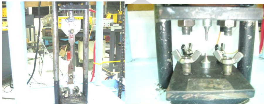
Gambar 5.6. Posisi spesimen lembaran dan silindris pada saat pengujian tarik
