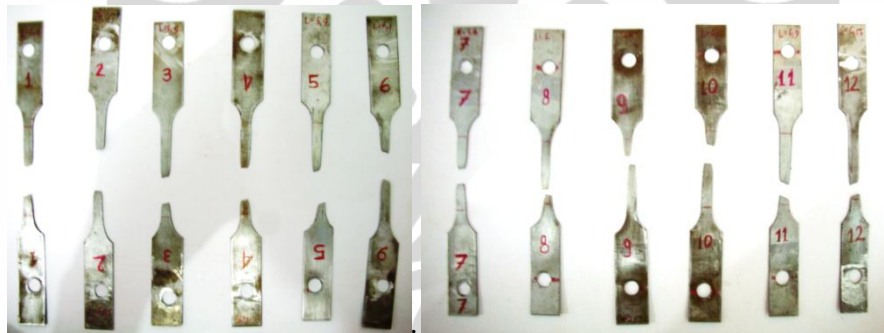
Gambar 5.7. Hasil pengujian tarik spesimen lembaran dengan mesin uji tarik prototip-3
