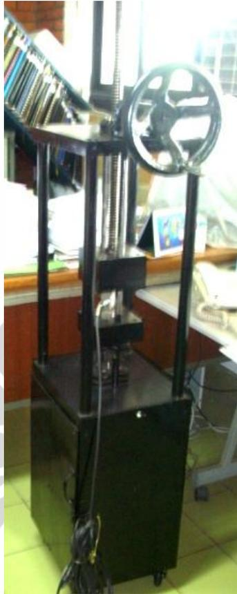
Gambar 4.1. Mesin uji tarik prototip-2
