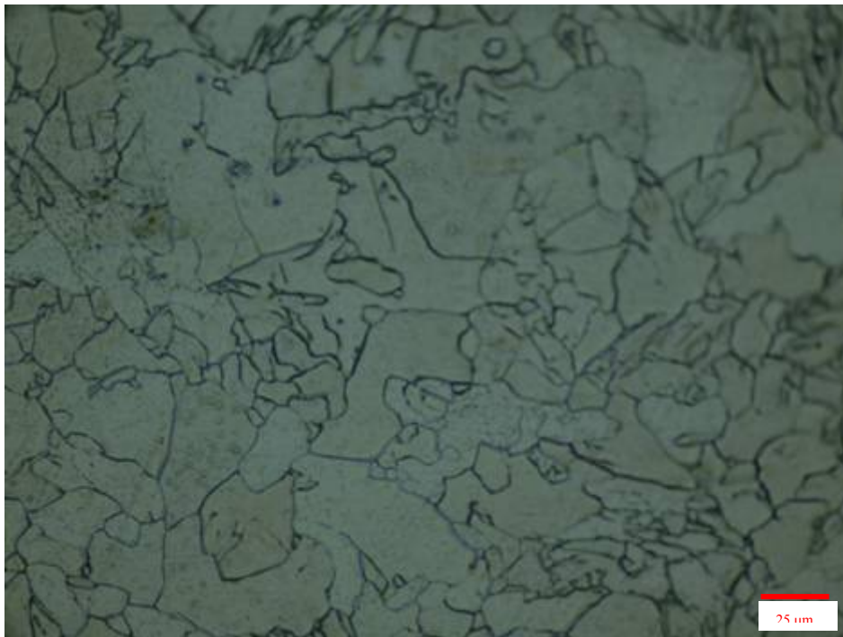
Gambar 4.2 Struktur Mikro Butir Austenit Baja C-Mn setelah Deformasi Panas, dengan \epsilon 0,1, pada temperatur T_1 1060 °C dengan waktu tahan t 1 detik. (Perbesaran 500X)
