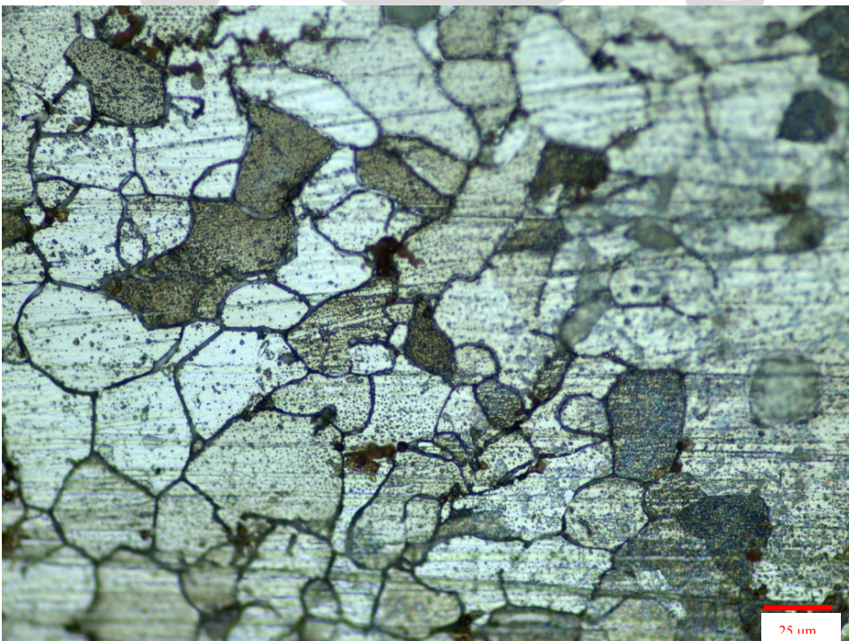
Gambar 4.7 Struktur Mikro Butir Austenit Baja C-Mn setelah Deformasi Panas, dengan \epsilon 0,2, pada temperatur T_1 1060 °C dengan waktu tahan t 10 detik. (Perbesaran 500X)
