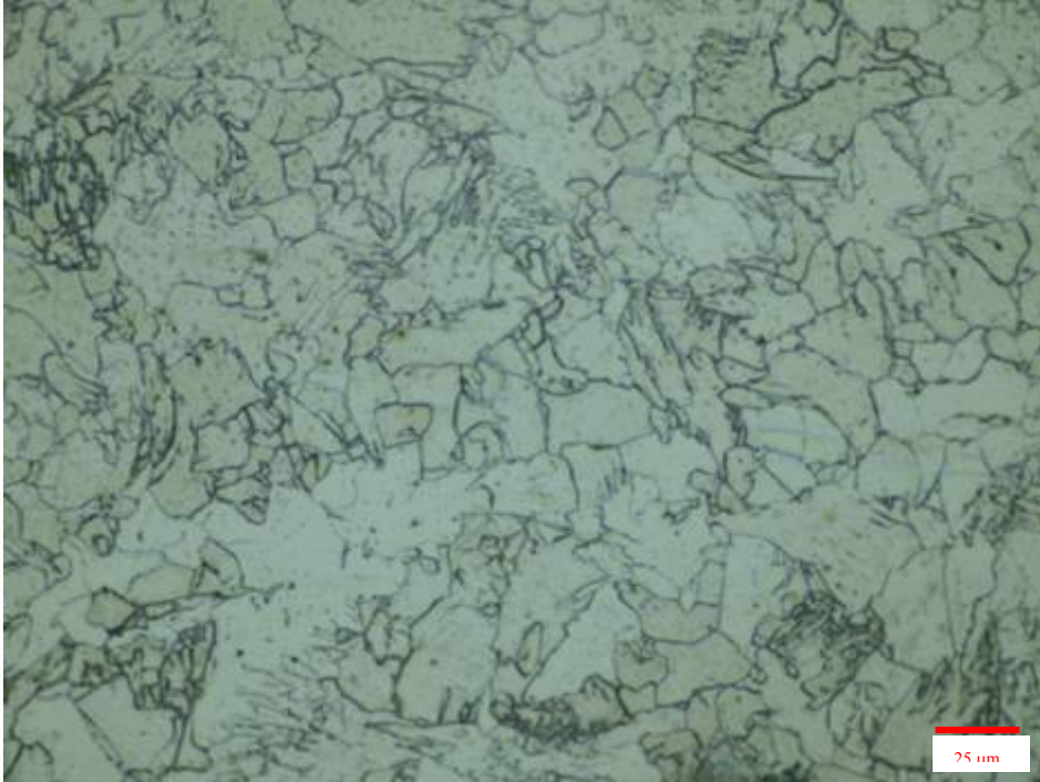
Gambar 4.4 Struktur Mikro Butir Austenit Baja C-Mn setelah Deformasi Panas, dengan \varepsilon 0,1, pada temperatur T_1 1060 °C dengan waktu tahan t 10 detik. (Perbesaran 500X)
