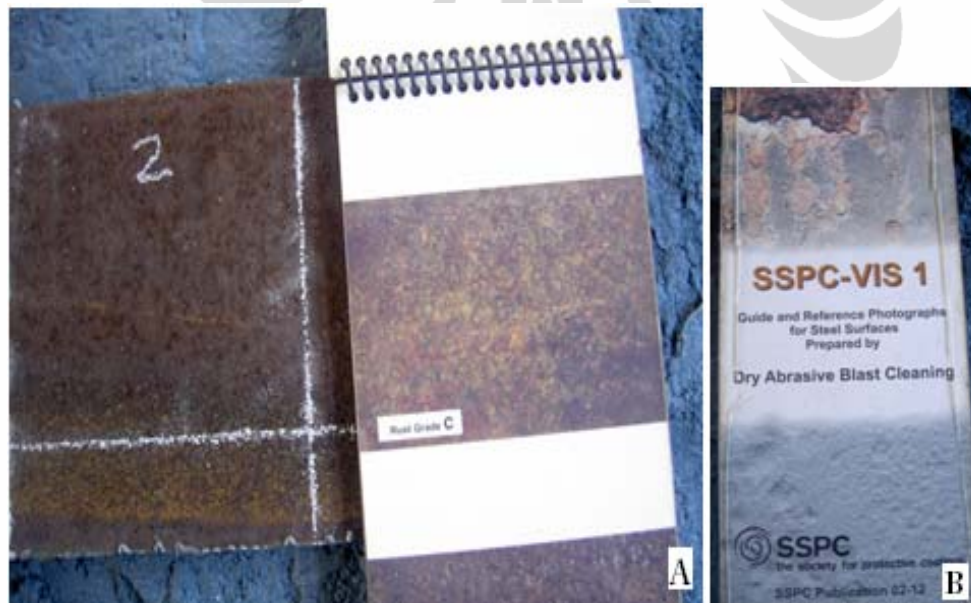
Gambar 4.1. A. Sampel uji memiliki tingkat karat Grade C, B. Standard gambar acuan SSPC-Vis 1
