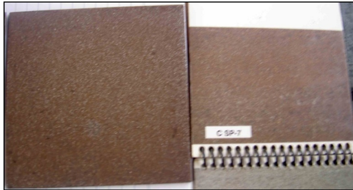
Gambar 4.3. Pengujian hasil persiapan permukaan SP 7 dengan acuan gambar SSPC Vis 1.
