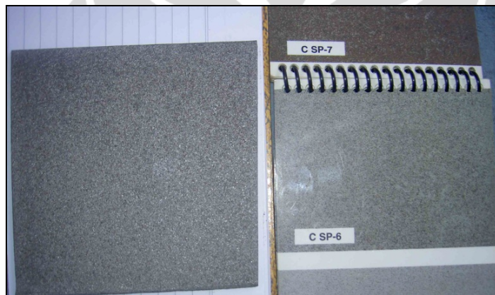
Gambar 4.4. Pengujian hasil persiapan permukaan SP 6 dengan acuan gambar SSPC Vis 1.
