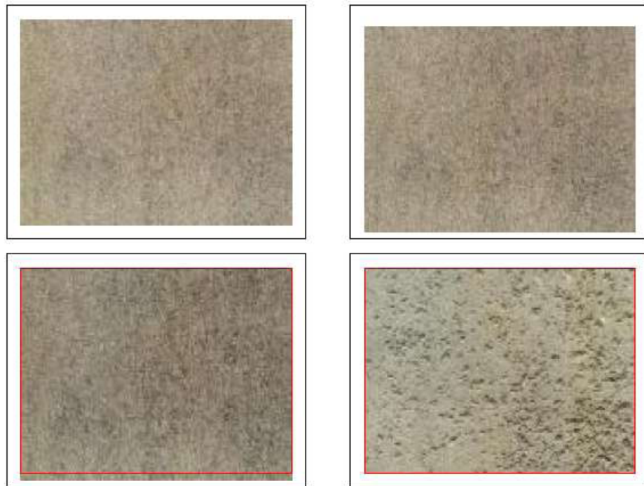
Gambar 2.15. Tingkat Kebersihan Blast Cleaning Sa 2.5 berdasarkan ISO 8501-2003. Setelah kondisi permukaan memadai, paling lama 6 jam kemudian harus segera dilakukan pengecatan (primer).
