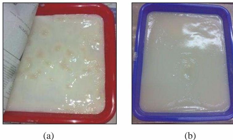
**Gambar 4.5.** Serat *Nata de coco*: (a) dengan penambahan nanofiller  $\text{SiO}_2$  3% w/v Setelah 18 hari (b) tanpa penambahan nanofiller setelah 9 hari.
