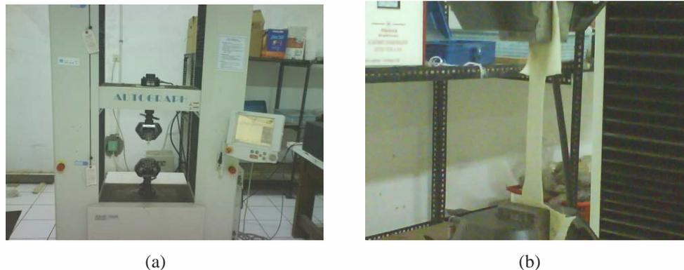
**Gambar 3.8.** (a). Alat Uji Tarik, (b). Proses Uji Tarik Serat *Nata de coco*
