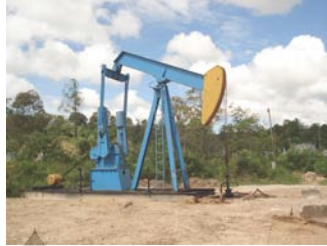
Foto 4.2 Jenis Alat Pompa Minyak (Pompa Angguk) di Daerah Kampung Satu Tarakan. (Foto: Salam 2010)
