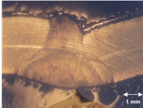
Gambar Pengamatan Foto Makro Sampel 7, Ketebalan 1,5 mm, Metoda GTAW Dengan Filler TGX
