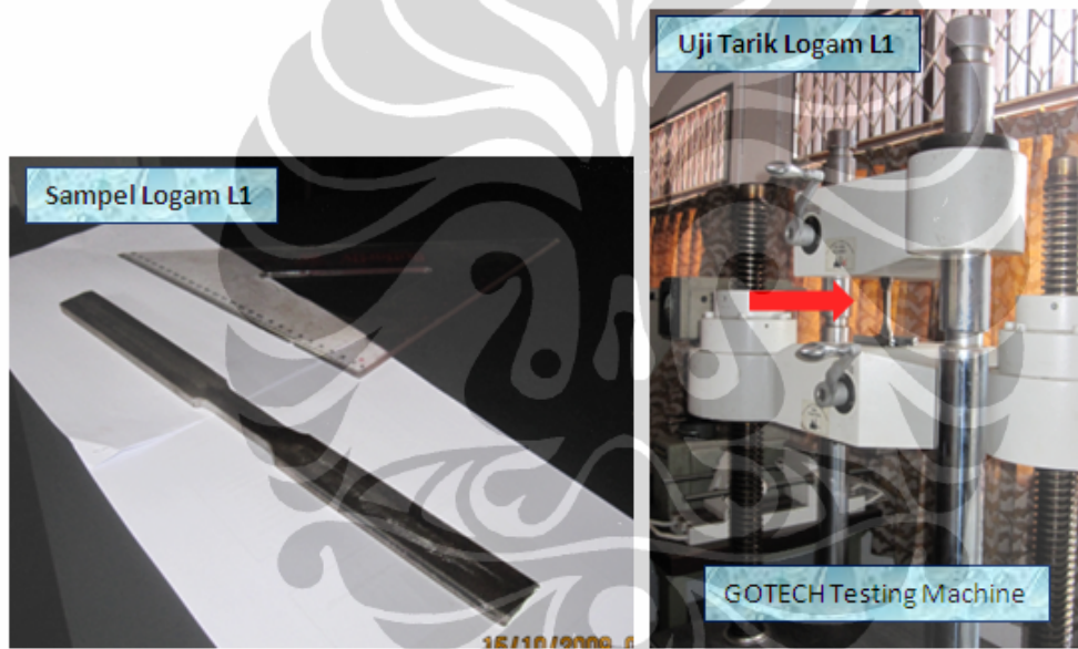
Gambar 3.9. Sampel logam L1 dan saat pengujian
