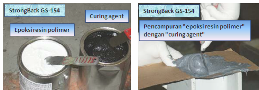
Gambar 3.5. StrongBack GS-154 dan pencampuran epoksi dengan curing
