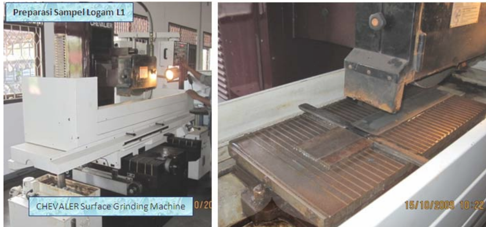
Gambar 3.8. Preparasi sampel logam L1
