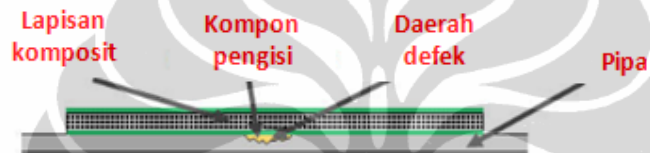
Gambar 1.2. Ilustrasi metode perbaikan dengan penguatan komposit polimer
