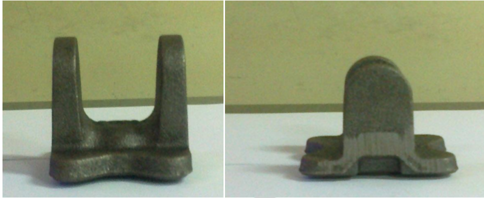
Gambar4. 2 Flange yoke setelah proses sand casting (sebelum perubahan desain)
