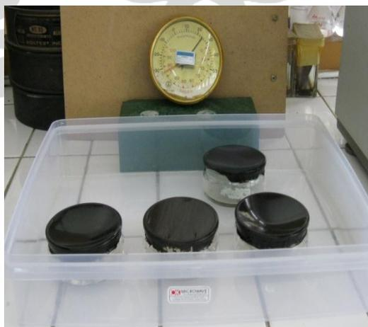
Gambar 3.5 Wajan untuk Uji *Water Vapor Permeability*
