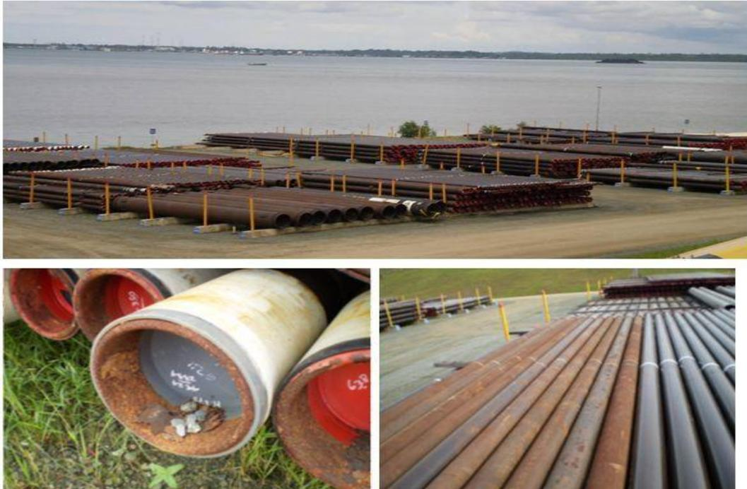
Gambar 1.1 Kondisi Pipa dan Tubing ditempat penyimpanan (*supply base*)
