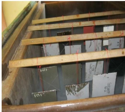
Gambar 3.8 Susunan sampel dalam kabinet uji sembur kabut garam
