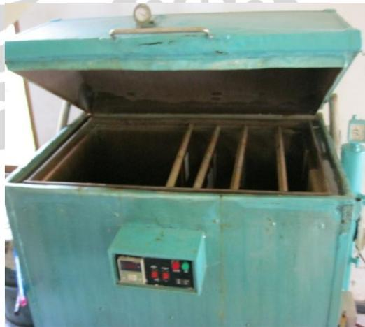
Gambar 3.7 Alat uji sembur kabut garam (Lab kimia B4T Bandung)
