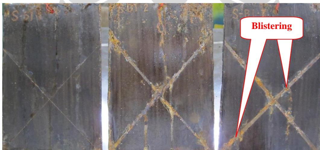
Gambar 4.17 Hasil Pengamatan Uji Sembur Kabut Garam *coating Semi clear* 1 (Sampel B1 dengan DFT 50 $\mu$ m)
