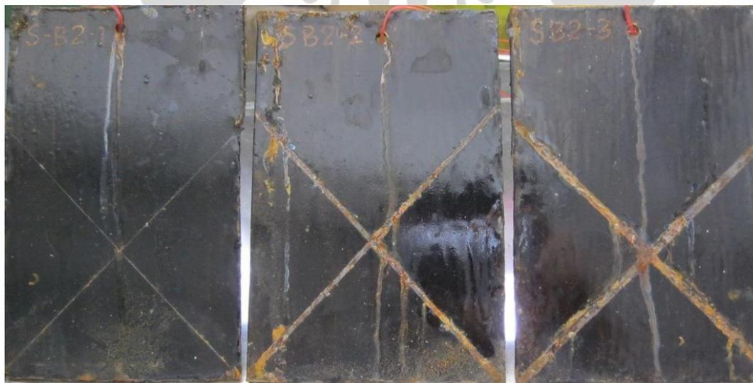
Gambar 4.18 Hasil Pengamatan Uji Sembur Kabut Garam *coating Semi clear 2* (Sampel B2 dengan DFT 80 $\mu$ m)
