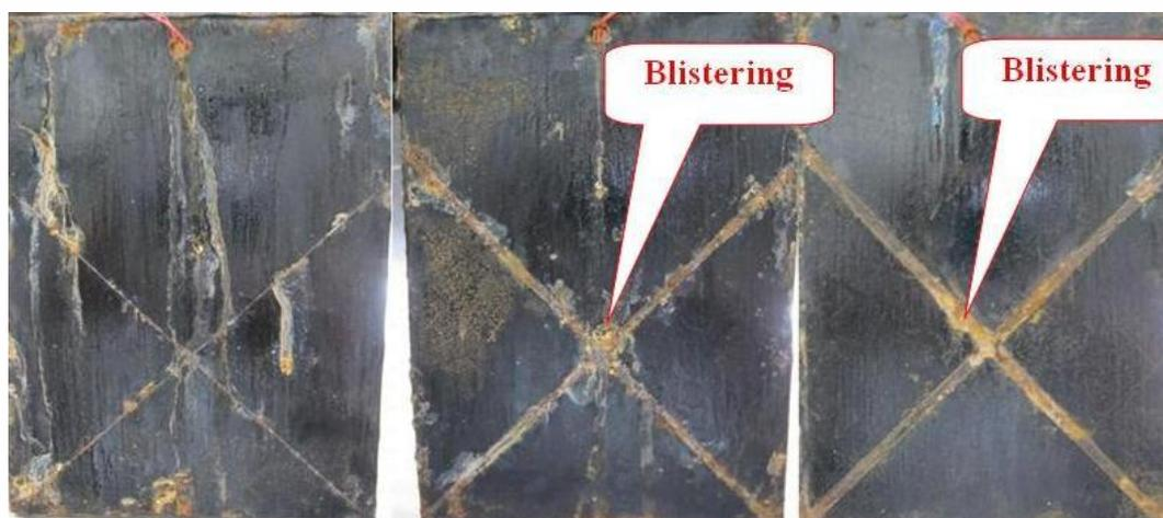
Gambar 4.16 Hasil Pengamatan Uji Sembur Kabut Garam *coating Black* (Sampel A dengan DFT 50 $\mu\text{m}$ )
