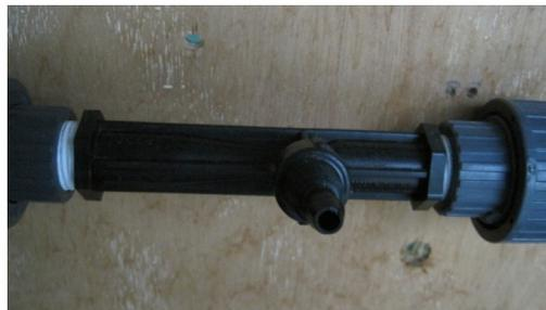
**Gambar 3.3.** Injektor Tipe Venturi Merk Mazzei
