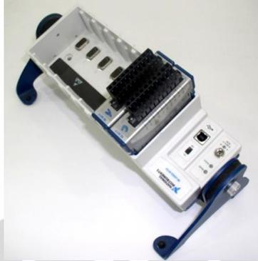
Gambar 3.4 *Data Acquisition* dan modul temperatur
