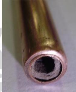
Gambar 3.4 *Heat pipe* dengan struktur *wick Sintered metal powder*
