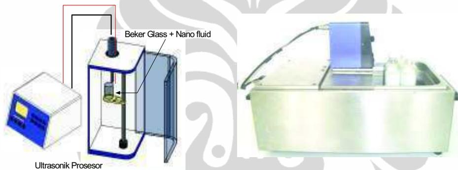
Gambar 3.1 Pembuatan Fluida Nano dengan Ultrasonic Processor dan pendinginan dengan thermostatic circulating bath
