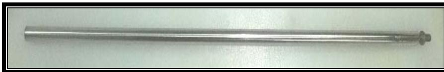
**Gambar 3.2.** Elektrode tegangan tinggi dari bahan SS-304
