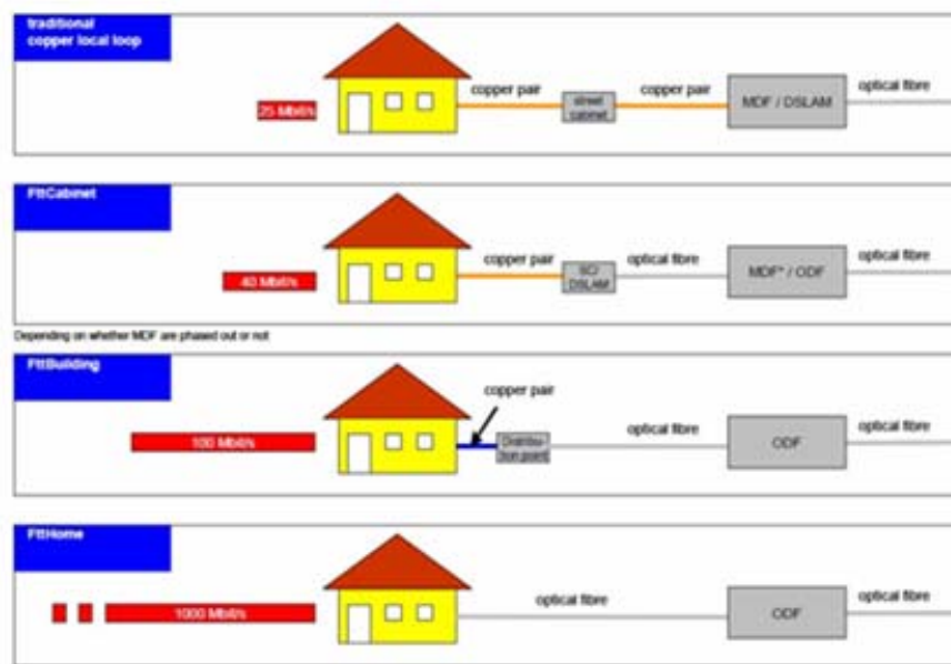
Gambar 2.11 Arsitektur akses menggunakan fiber optik
