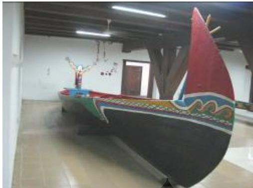
Perahu Comprengh dapat dimuati dua sampai tujuh orang nelayan dalam satu kelompok, tergantung pada ukuran perahu tersebut. Perahu jenis ini menggunakan layar dan mesin tempel sebagai alat penggerak. Mesin tempel digunakan bila tidak terdapat angin yang dapat mendorong laju perahu.
