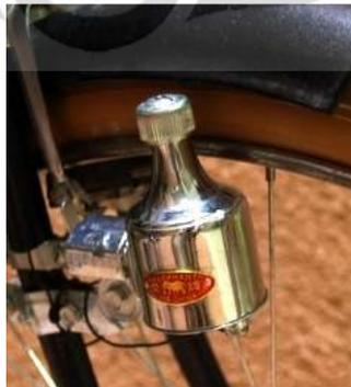
**Gambar 2.8 Dinamo Sepeda [10]**
