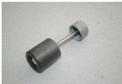
**Gambar 3.8 Rotor Pada Dinamo Sepeda**
