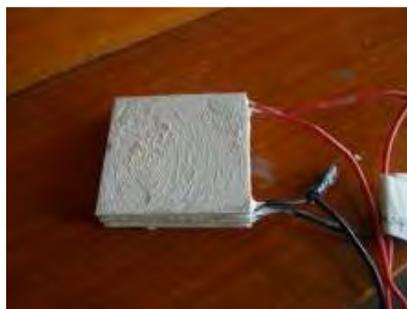
Gambar 3.6 elemen termoelektrik bertingkat dua
