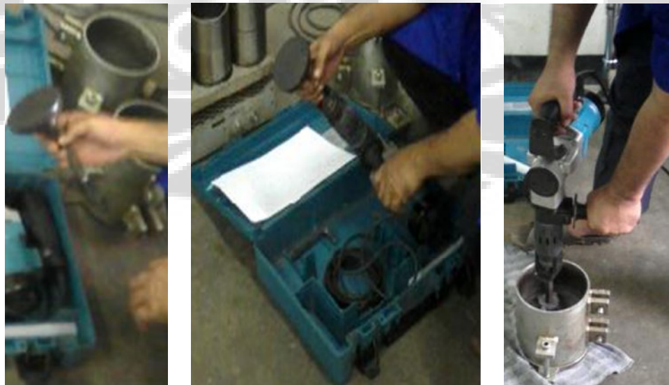
Gambar 3.4 Alat Pemadat Getar Benda Uji PRD.
