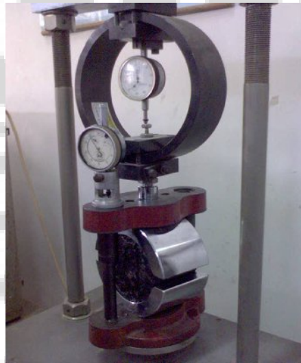
Gambar 3.3 Alat Uji Marshall
