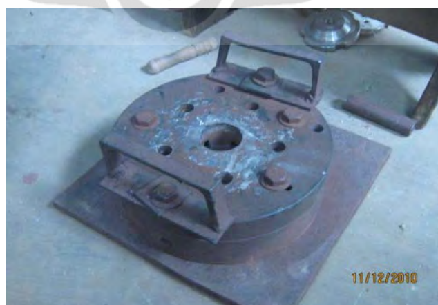
Gambar 3.3 Cetakan permanen (baja karbon rendah)
