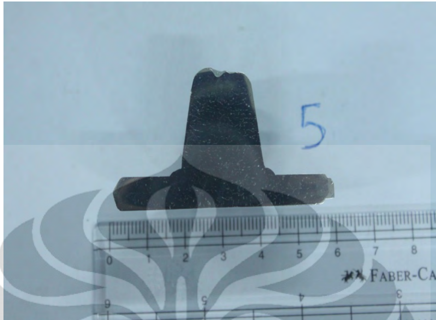
Gambar 4.2 Produk cor ketebalan 5mm setelah dibelah dua bagian
