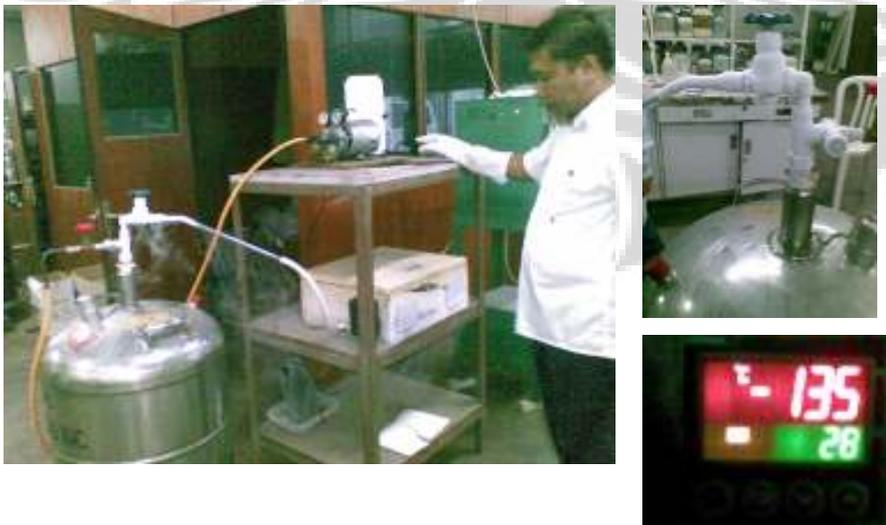
Gambar L1.1. Proses quenching dengan Nitrogen cair.
