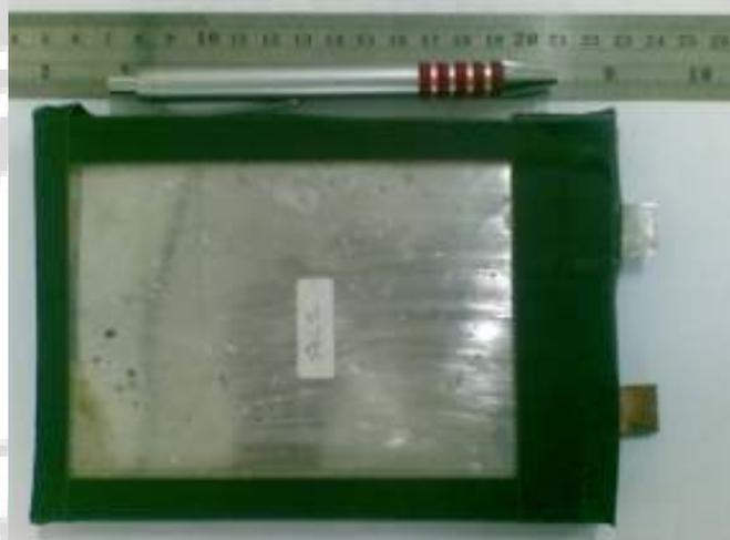
**Gambar 4.19.** Prototip sel baterai lithium keramik LTO/LATP/LMO.
