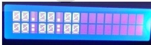
**Gambar 4.5** Tampilan Awal LCD Pengujian RTC dan Keypad
