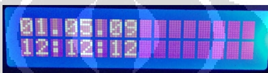
Gambar 4.11 Tampilan LCD Setelah Set Waktu dan Tanggal
