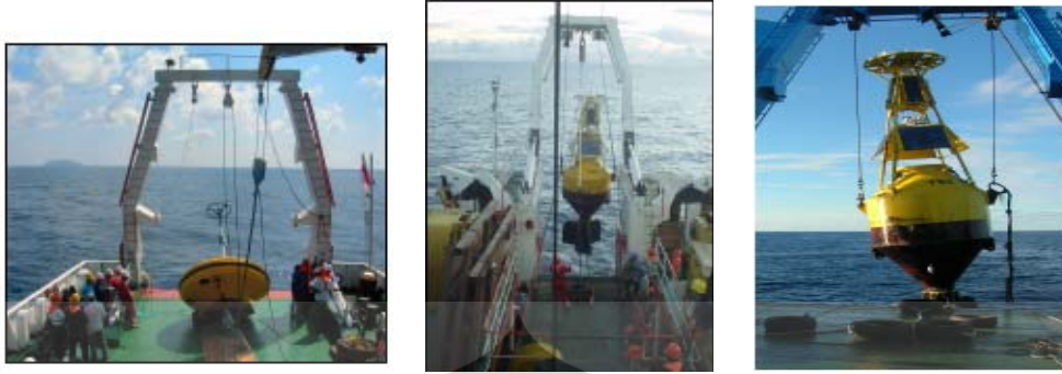
Gambar 2.15. Proses pengujian kestabilan buoy di laut
