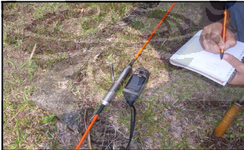
Gambar 3.5. Proses penentuan koordinat elektroda dan pemasangan kabel.
