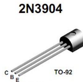
Gambar 2.7 Bentuk dari Transistor BJT tipe 2N3904
