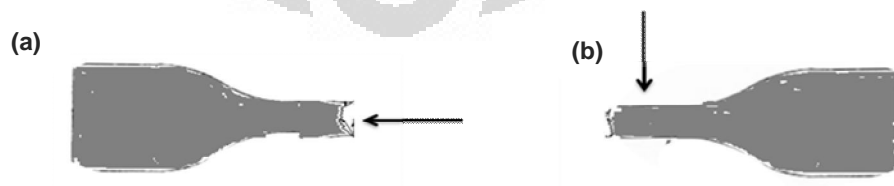
Gambar 3.7. Sampel hasil pengujian tarik untuk pengujian SEM pada bagian: (a) ujung dan (b) samping
