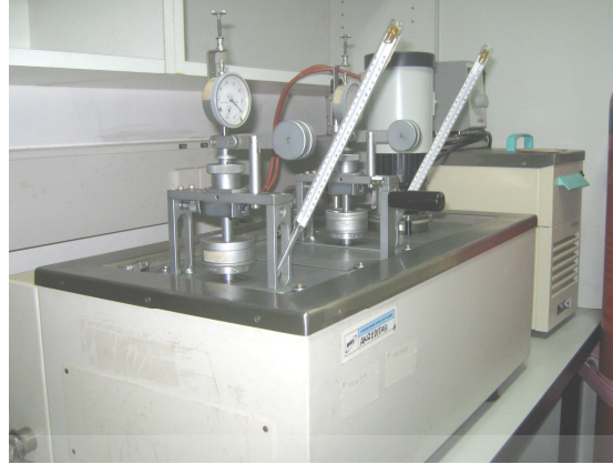
Gambar 3.6. Alat uji HDT Lauda FRANK Prüfgeräte GmbH 40071
