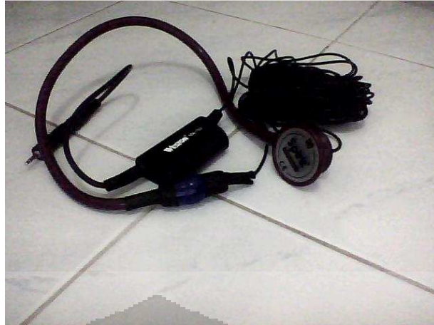
Gambar 3.2 Sambungan Electret Condenser Microphone dengan Stetoskop
