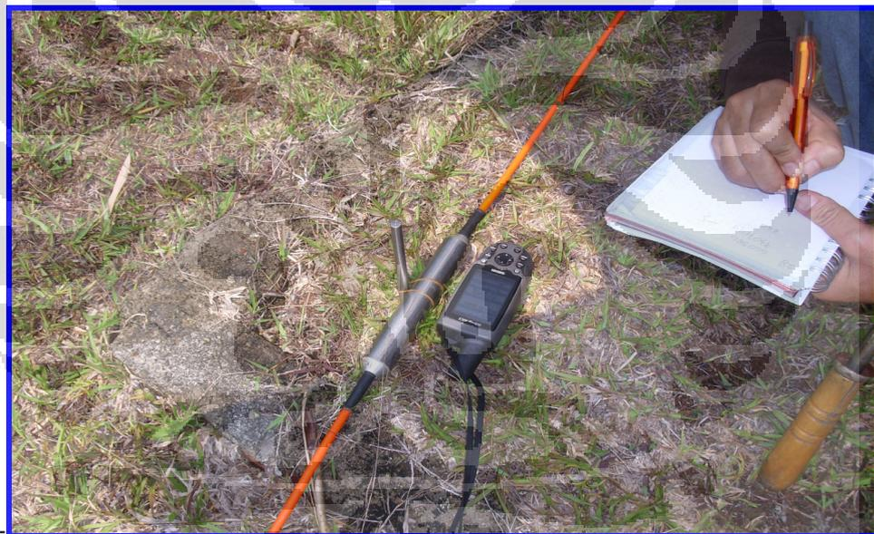
Gambar 3.9: Pengukuran posisi-posisi setiap elektroda dengan menggunakan GPS
