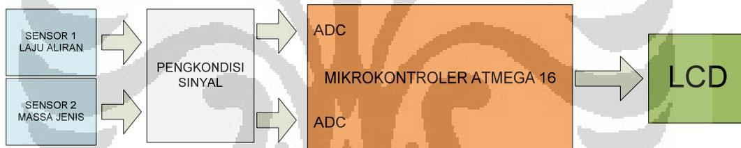
Gambar 3.1. blok diagram Venturimeter berbasis Mikrokontroler
