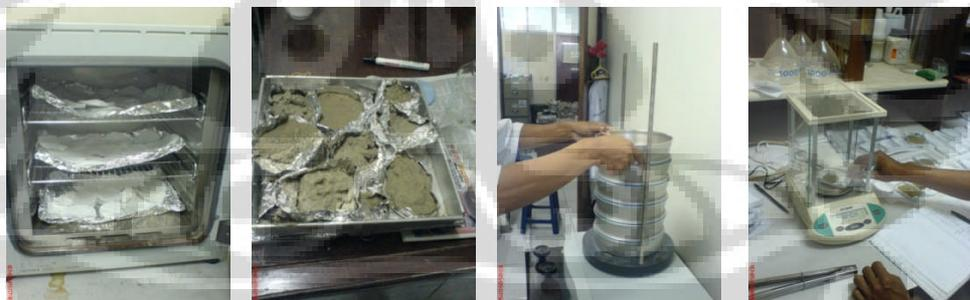
Gambar 3.2 Pengujian Labolatorium Sampel Sedimen (dokumentasi pribadi, 2009)
