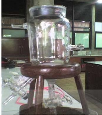
**Gambar 4.14** Reaktor yang digunakan dalam sistem aliran kontinyu.
