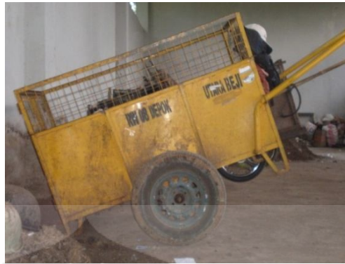
Gambar 4.2 Gerobak yang Digunakan dalam Sistem Pengumpulan Sampah (Dokumentasi Penelitian, 2011)
