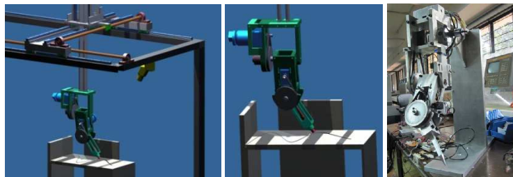
Gambar 2.10 Mesin las 5 derajat kebebasan (6)
