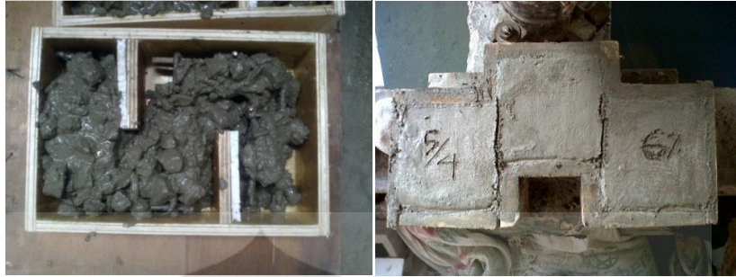
Gambar 4. 12 Beton Segar di Bekisting Benda Uji
