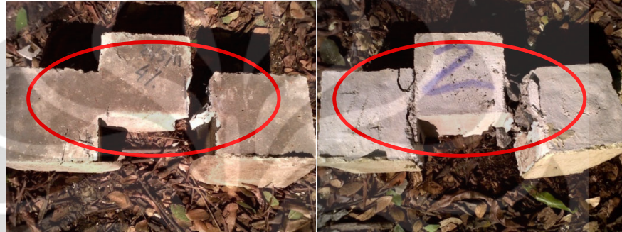
Gambar 4. 25 Hasil Uji Geser dengan Mekanisme Double Shear
