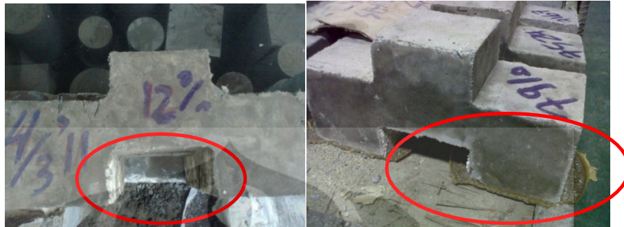
Gambar 4. 19 Penggunaan Styrofoam dan Capping pada Benda Uji Geser Kubus
