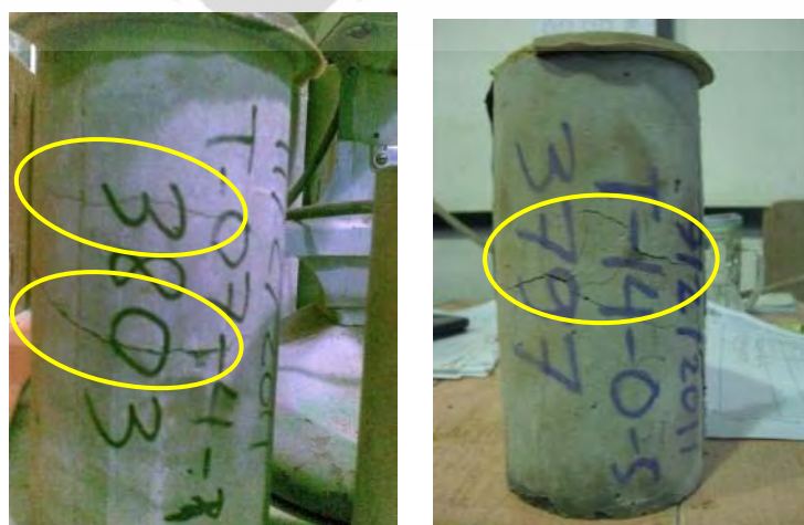
Gambar 4.23 Pola Retak yang Tidak Wajar/Geser
