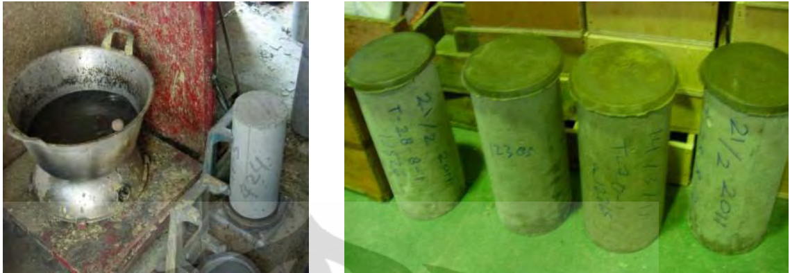
Gambar 4.20 Proses Capping Beton dan Beton yang telah dicapping
