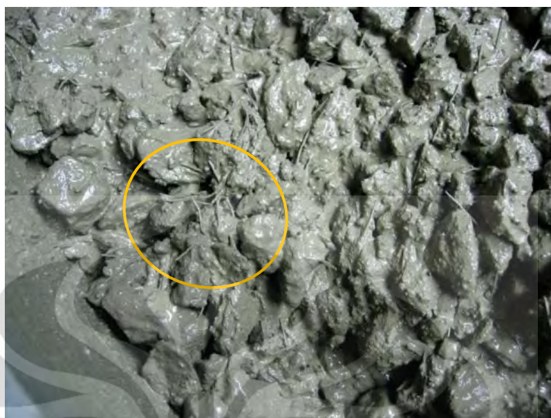
Gambar 4.17 Peristiwa terjadinya BallingEffect
