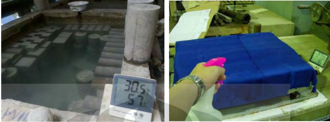
Gambar 4.12 Proses Curing Beton di kolam beton (benda uji tekan) dan disemprot (benda uji susut)
