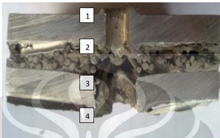
Gambar 4.12 Jalur laju masuk peluru ditandai dengan no 1-4
