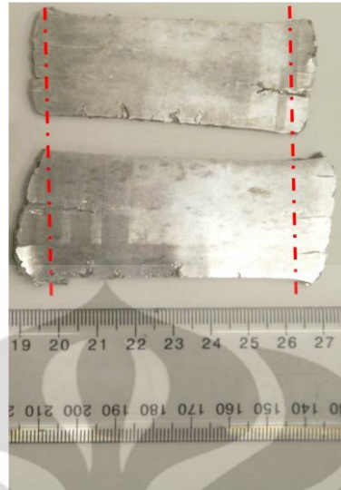
Gambar 4.9. Cacat pengerolan overlap dan fishtail pada pengerolan paduan Al-Zn-Mg-Cu. Untuk membedakan kedua cacat ini, korelasikan Gambar 4.9 dengan Gambar 2.21.
