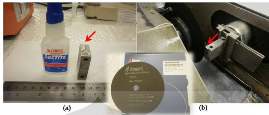
Gambar 3.62. (a) Penempelan sampel pada balok logam dengan Loctite 460 instant adhesive . (b) Proses pemotongan melintang dengan aluminium oxide cut off wheel 50A13 pada mesin potong Struers Accutom-50 ver 3.3.
