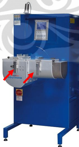
Gambar 3.19. Crucible dan mold chamber harus dipastikan terkunci dengan baik (ditunjukkan dengan tanda panah).
