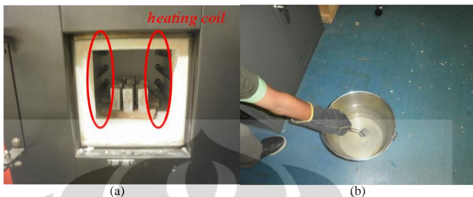
Gambar 3.30. (a) Peletakkan sampel pada muffle furnace harus diperhatikan agar tidak menyentuh heating coil di dalam mesin. (b) Proses quenching setelah homogenisasi.
