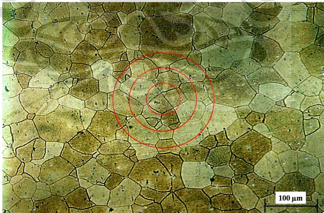
Gambar 5.4. Contoh penggunaan lingkaran standar ASTM E 112 – 96 untuk penentuan besar butir. Sampel di bawah lingkaran merupakan paduan Al-1.7Zn-1.7Mg-0.4Cu (at.%) setelah ageing selama 24 jam (tanpa garis presipitat di dalam butir) dengan perbesaran 100X menggunakan etsa Keller's reagent.
