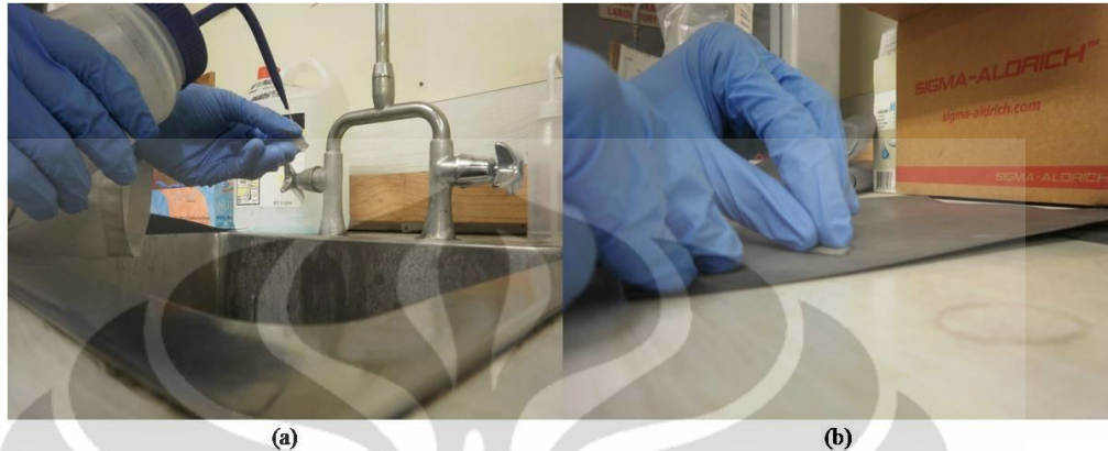
Gambar 3.47. Persiapan sampel pre-ageing sebelum pengujian kekerasan. (a) Pembersihan dengan etanol. (b) Pengamplasan dengan kertas amplas #2000.
