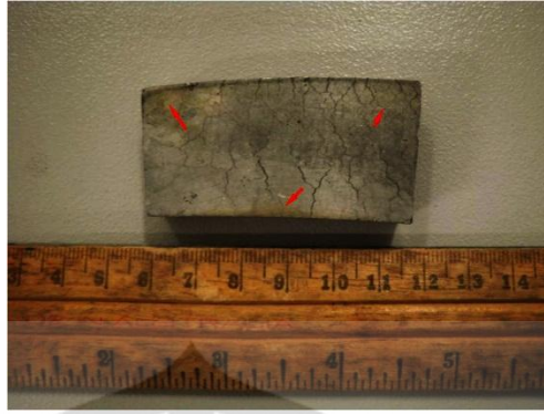
Gambar 4.6. Oksida pada permukaan billet yang terbentuk karena pengerolan panas.
