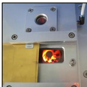
Gambar 3.24. Jendela untuk mengamati proses peleburan, terlihat pelat emas yang dapat digunakan untuk mengurangi radiasi cahaya.
