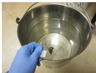
Gambar 3.45. Proses quenching dari oil bath .
