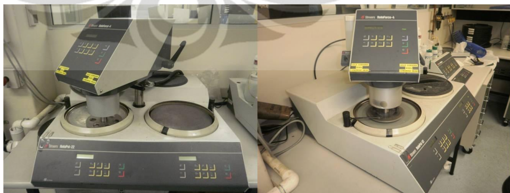
Gambar 3.54. Mesin grinding Struers RotoPol-22, disebelah kiri adalah tampak depan mesin (sedang off ) dan disebelah kanan adalah tampak samping mesin (sedang beroperasi).
