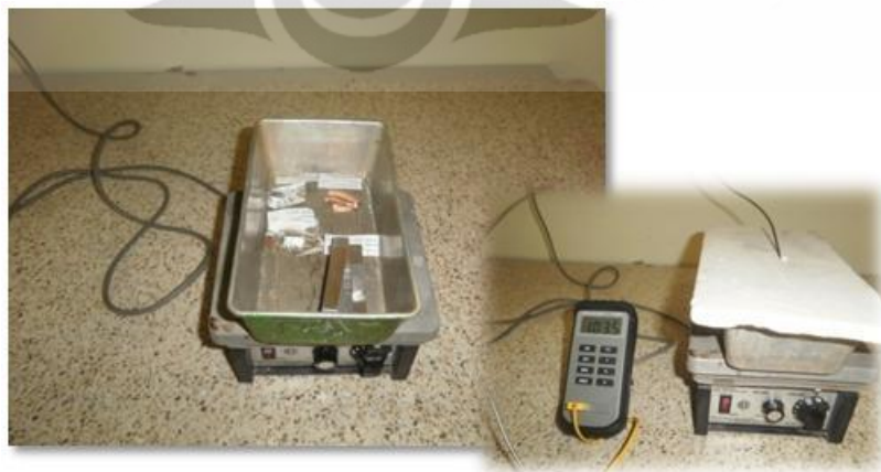
Gambar 3.14. Proses preheating material umpan pada temperatur 100-120 °C selama \pm 15 menit.
