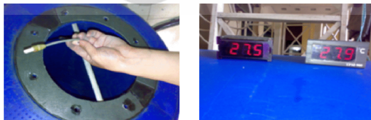
Gambar 3.10 Termokopel dan display pada digester
