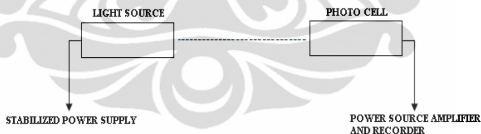
Gambar 2.7 Gambaran peralatan yang dibutuhkan dalam pengukuran optical density [1]
